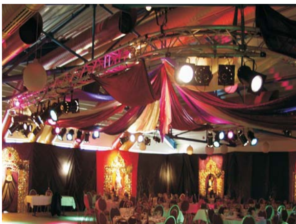
unten rechts: Pro Wein unten links: Silvestergala -wenn keine störenden Stützen den Stand begrenzen sollen , kann die gesamte Konstruktion auch "geflogen" werden , dabei wird der Aufbau mittels Hand / Motorkettenzügen auf die gewünschte Höhe gezogen + gesichert.
